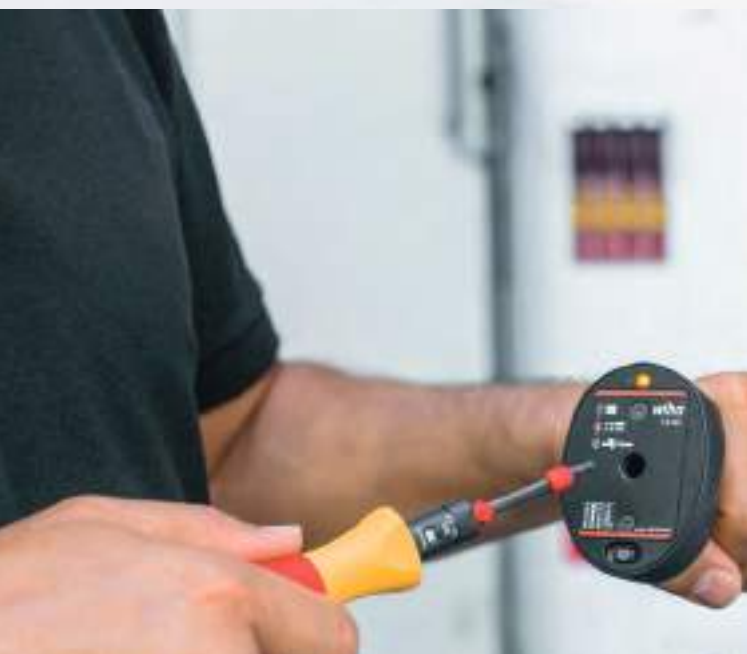
Mobil hurtigtester til kontrol af momentværktøj
